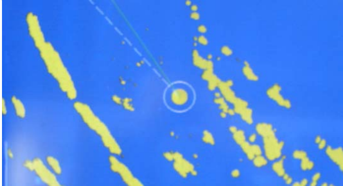
Figure 10 – Image du chenal Pike-Resor, obtenue au moyen du radar en bande X.
