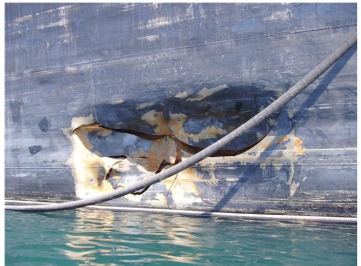
Figure 1. Dommages causés par la glace à un navire-pétrolier
